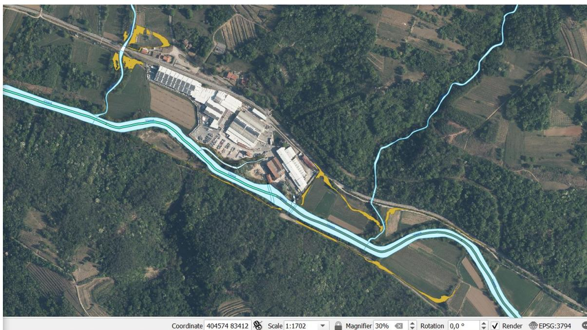
Slika 28: Prikaz razlivnih površin na vplivnem območju posega, predvideno stanje po izgradnji protipoplavnih objektov. Vir: IzVRS (2017).
