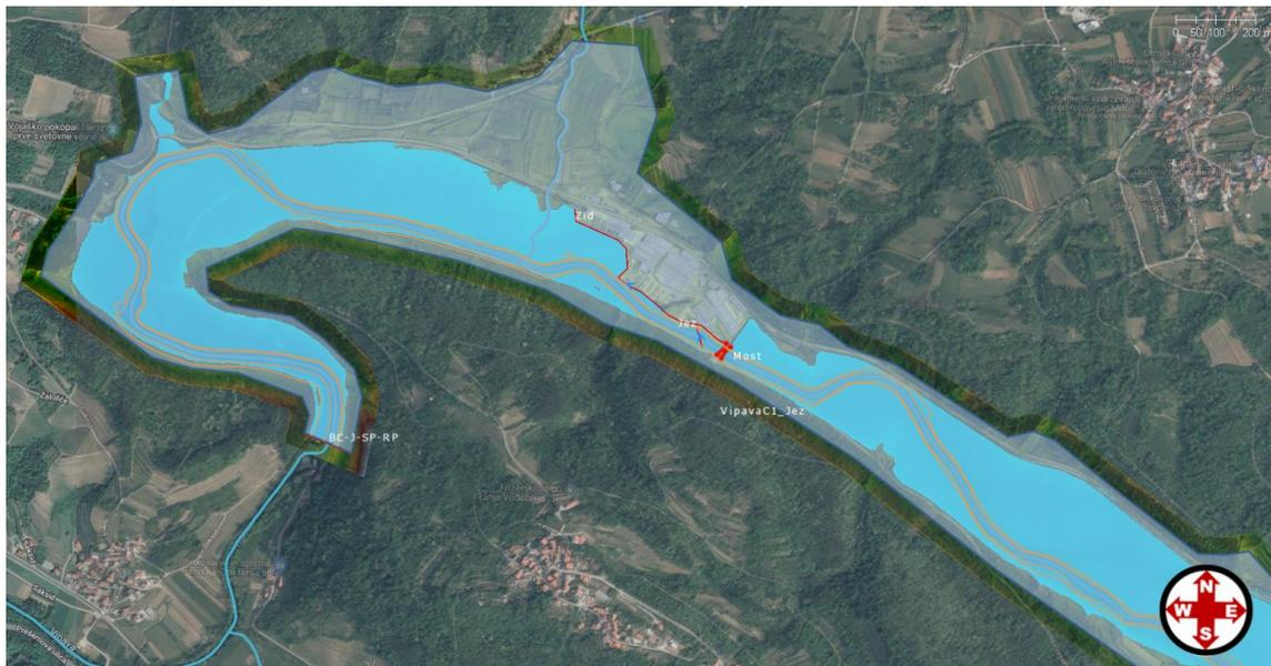
Slika 20: Prikaz hidravličnega modela za novo stanje
