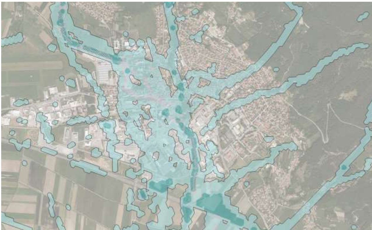
Slika 6.60: Rezultat poenostavljenega modeliranja odtoka padavinskih voda (nivo identifikacije stanja) – hidrološka obremenitev: 80mm/1h.
