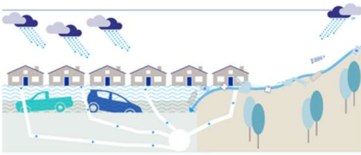
Slika 1.7: Mehanizem nastanka pluvialnih poplav
