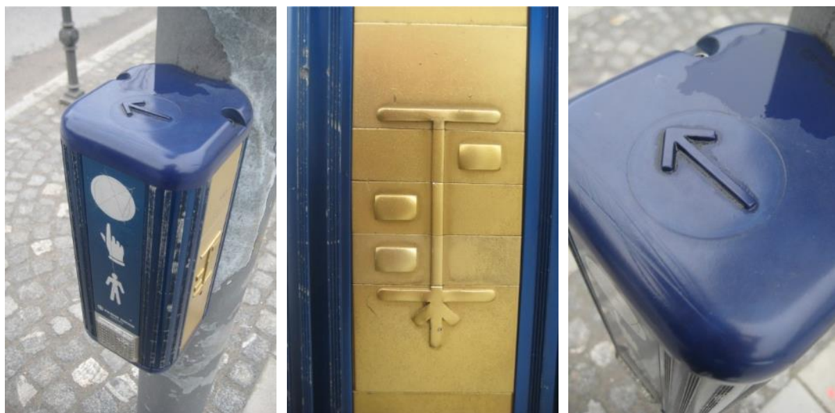
Slika A: Ustrezno opremljen zvočni semafor. Slika B: reliefna puščica na vrhu škatlice semaforja slepi osebi sporoči smer v kateri lahko prečka cesto. Slika C: Na navpični stranici škatlice semaforja lahko slepi otipa postavitev prometnih pasov in dobi občutek o velikosti ceste, ki jo namerava prečkati.
